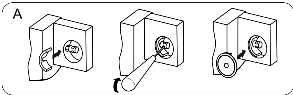
Порядок сборки сегментных стяжек: в отверстия царги 04 вставить сегменты и с помощью шила завернуть винты до упора. В отверстия вставить заглушки.
