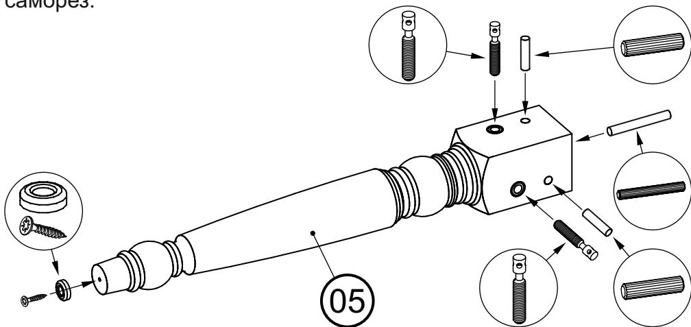
Соединить царги 04 и опоры 05 между собой, совместив винты и шканты с отверстиями сопрягаемых деталей. Зафиксировать детали с помощью сегментных стяжек.
